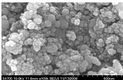
图 1 纳米铝粉的 SEM 照片
