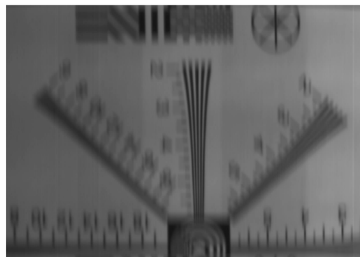
图 8 积分级数为 48 时行周期误差率为 10% 的图像 Fig. 8 Image at 48 integral grade with \Delta T/T=10\%
