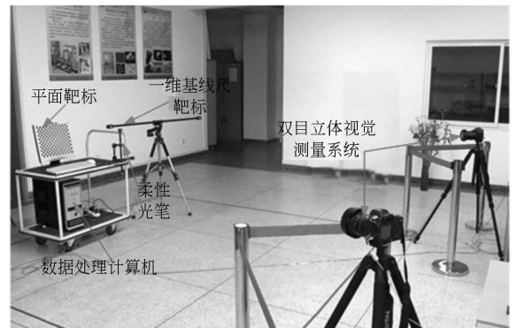
图 1 光笔式大视场三维视觉测量系统组成
