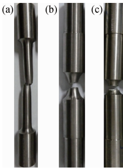
图 2 3 种拉伸试样宏观断裂形貌
