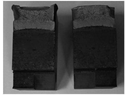
图 9 CT 试样裂纹断面
