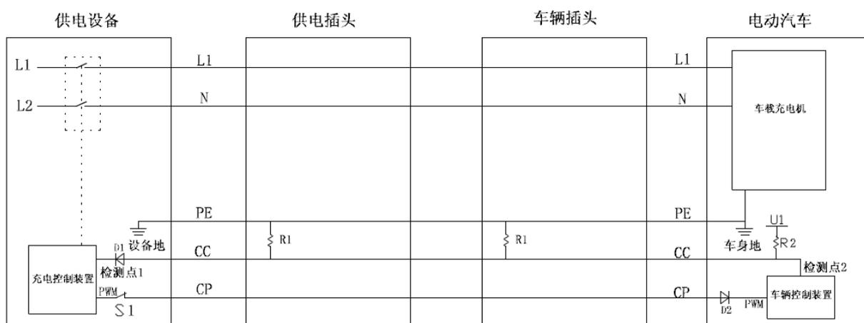
图 A1 典型的控制导引电路原理图
