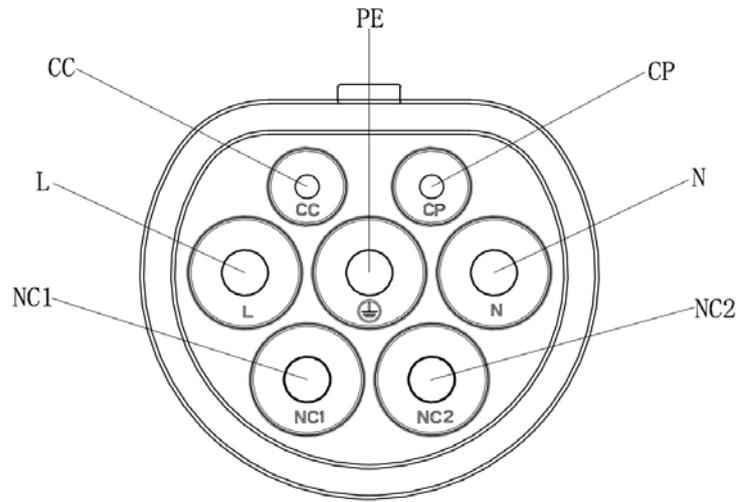
图3 车辆插头触头布置图
