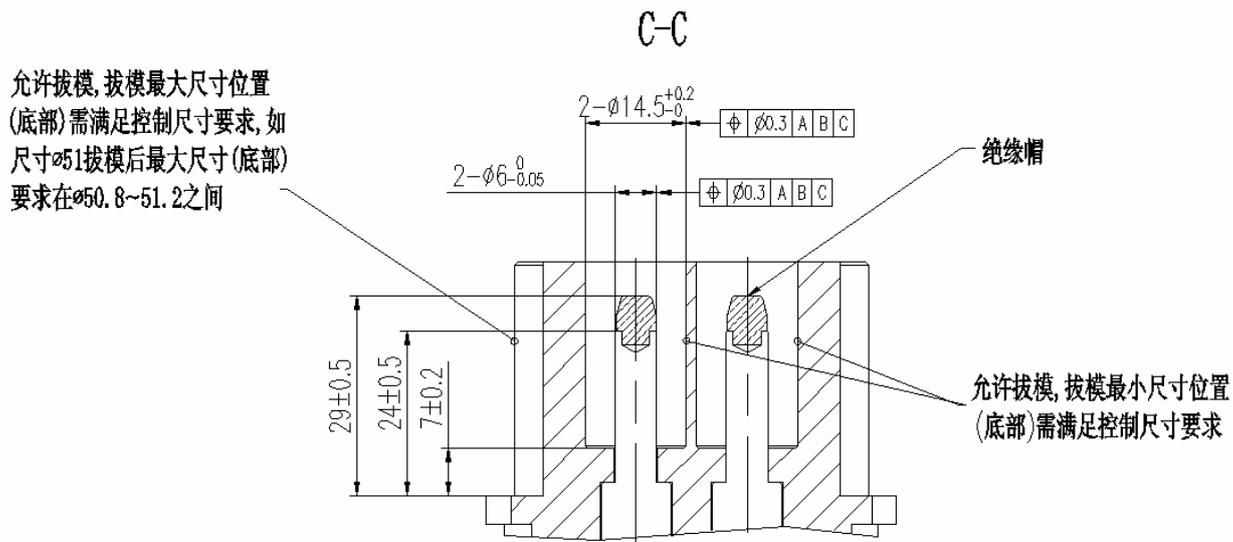
图 B3 车辆插头结构尺寸
