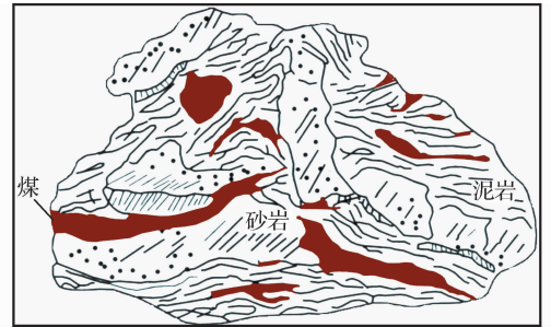
图2 告成煤矿构造煤变形素描
