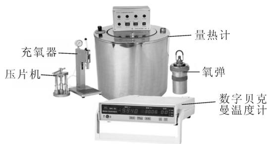
图1 燃烧热装置
