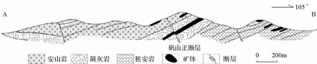
图3 矾山明矾石矿床剖面图(据安徽省地勘局 327 地质队,1956 修改)
