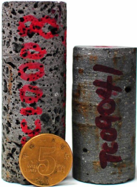
图3 开展三维 CT 立体扫描的腾冲火山区黑空山玄武质熔岩流柱状样品
