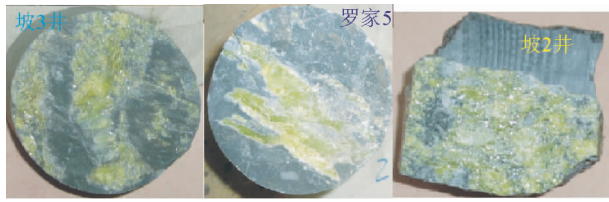
图 10 川东北飞仙关组储层岩心中的斑块状硫磺
