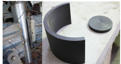
图 3 曲面摩擦副的滑移试验装置
