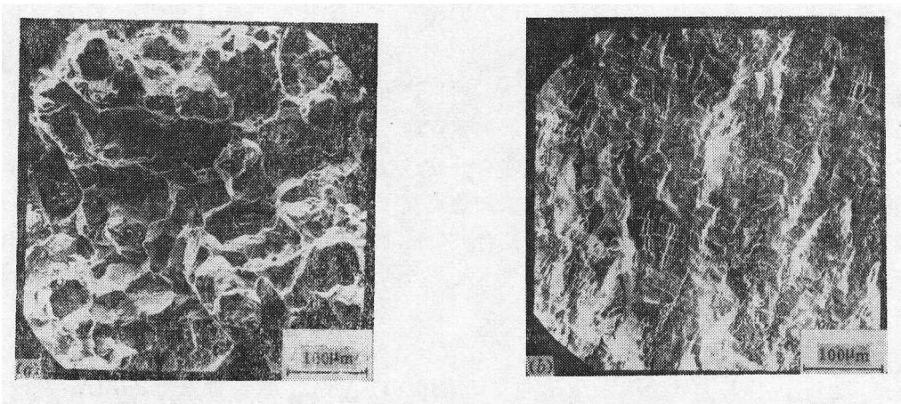
图 7 扫描电镜下的断口形貌, 两种不同的微观断裂机制 ( \Delta K_{\text{total}} = 30 \sim 40 \text{ MPa}\sqrt{m} ) (a) m = 0 沿晶断裂; (b) m = 0.12 穿晶断裂。
