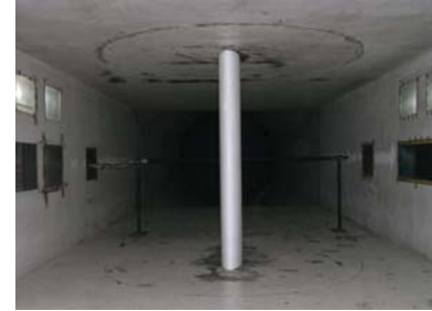
图3 翼型模型在 NF-3 风洞中的安装 Fig.3 The test model in NF-3 wind tunnel
