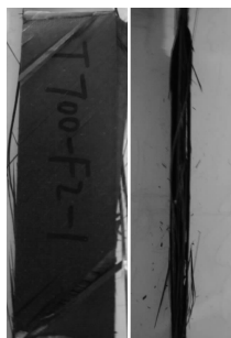
图3 光滑板的拉-拉疲劳破坏
