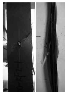
图5 含孔板的拉-拉疲劳破坏
