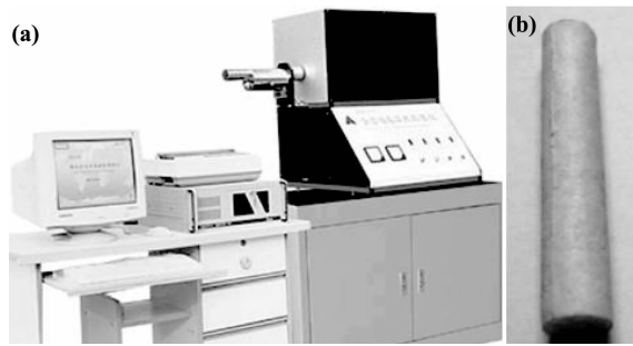
图 1 RPZ-03P 热膨胀测试仪 (a) 及 ZrO_2 - TiO_2 陶瓷测试试样 (b)
