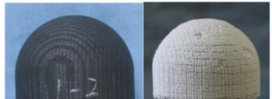
图1 碳/碳化锆模型烧蚀前后表面状况
