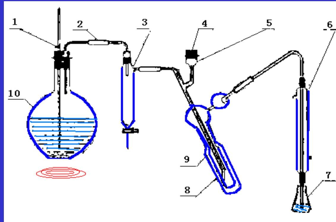
1. 安全管 2. 导管 3. 汽水分离器 4. 塞子 5. 进样口 6. 冷凝管
