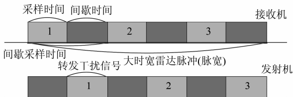
图 1 间歇采样转发干扰的基本原理
