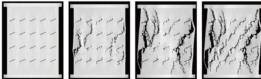
图 2 20 条 25° 倾角裂隙体的渐进破坏模式
