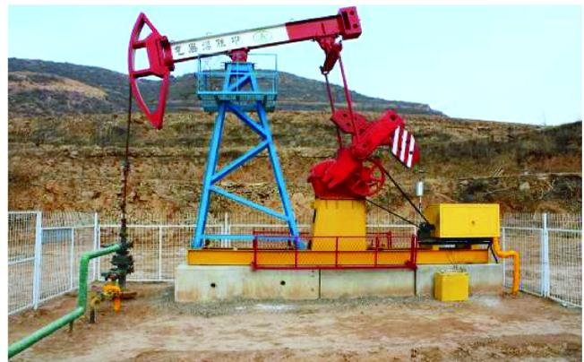
图8 气动机驱动煤层气生产照片
