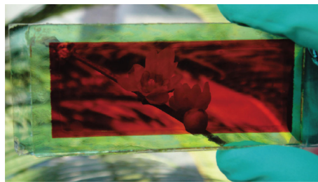
图 8 大面积透明 DSSC 的照片
