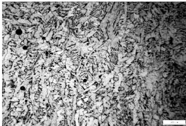
图7 焊缝焊肉外层显微组织,F+P+W(×100)
