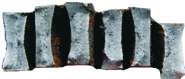
图 1 室温母材拉伸断口宏观形貌图
