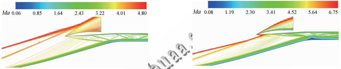
图8 变几何进气道 Ma=7.0 下的对称面流场结构
