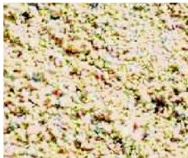
图1 水淬高炉矿渣
