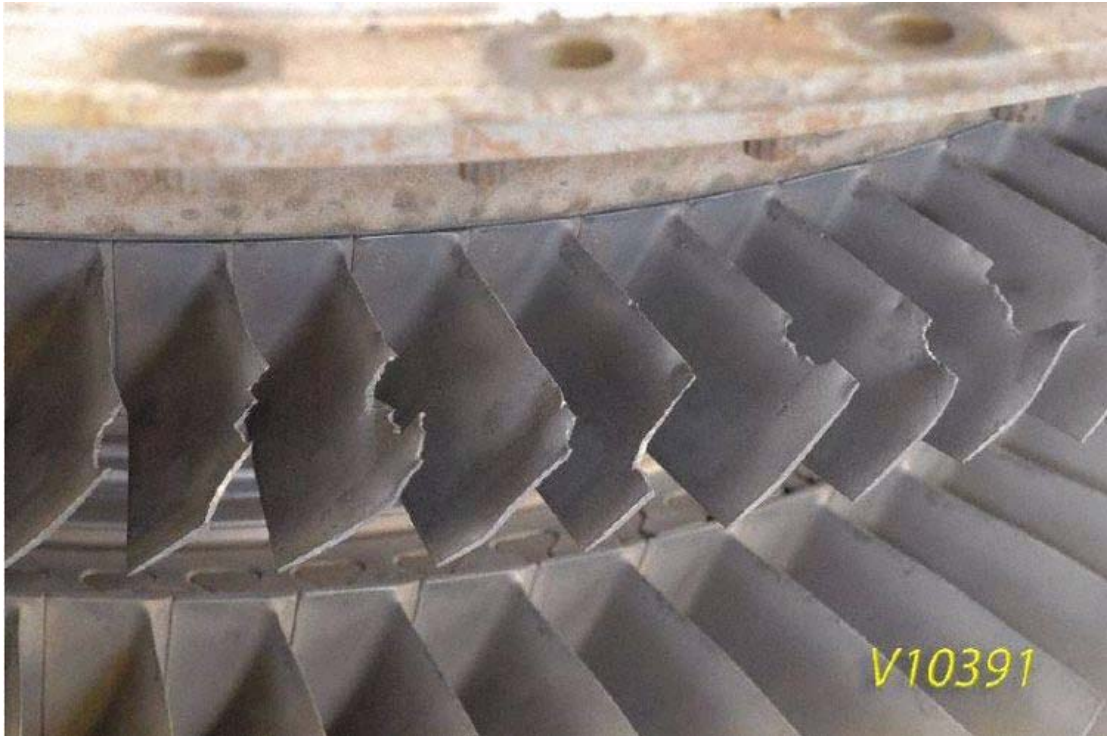
图 1：高压压气机第 6 级的损坏情况
