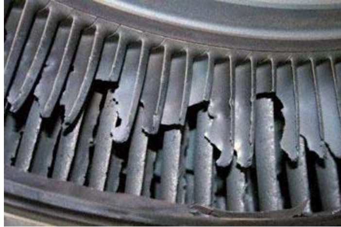
图 1：受损的一级低压涡轮叶片
