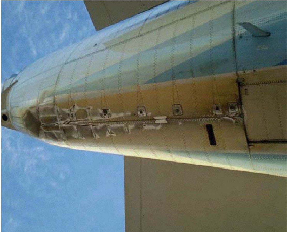
图 2：尾部磨损情况
