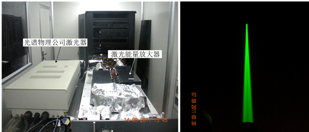
图 4 10 W 功率激光器、激光放大器及大能量激光束效果图
