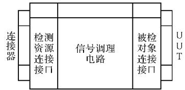
图 3 适配器结构示意图
