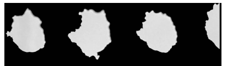
图 2 激光打 5 \mu\text{m} Al 靶后的烧蚀情况
