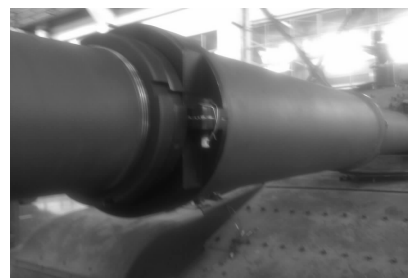
图3 改进后抽气装置双瓣固定环
