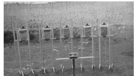
图 5 模拟弹丸与测速靶布置现场正视图
