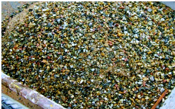
图4 返回的井底岩屑图
