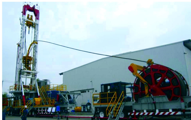
图2 CTR120/300复合连续油管钻机试验现场图
