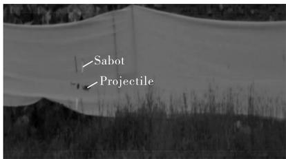
图 2 高速摄像机记录的弹丸与弹托分离照片
