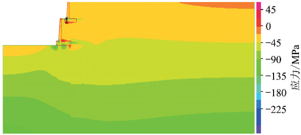
图 5 悬臂式挡土墙水平应力云图
