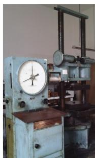
图1 压力试验机
