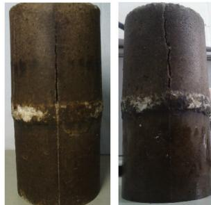
图 5 模型材料单轴压缩破坏
