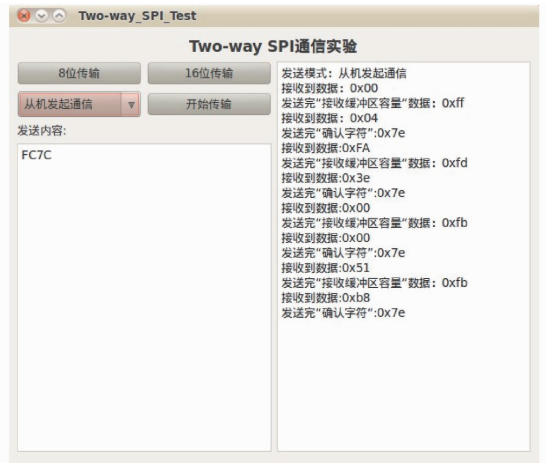
图 11 从机发起 two-way SPI 通信的测试情况
