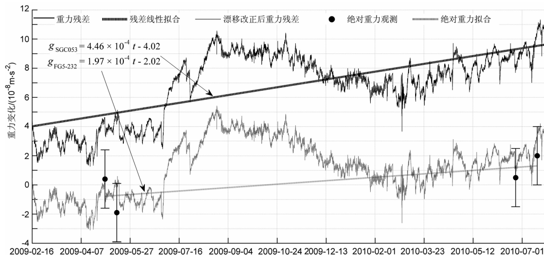
图2 利用FG5-232绝对重力测定法测定SGC053的观测漂移
