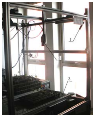
1. 线激光器 2. 彩色相机 3. 传送带 1. Linear laser 2. Color camera 3. Conveyor belt
