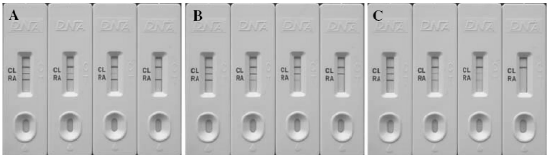
A. CL/RAC 浓度: 0/0, 0.5/0, 1.0/0 和 2.0/0 \text{ ng} \cdot \text{mL}^{-1} ; B. CL/RAC 浓度: 0/0, 0/1.0, 0/2.0 和 0/4.0 \text{ ng} \cdot \text{mL}^{-1} ; C. CL/RAC 浓度: 0/0, 0.5/1.0, 1.0/2.0 和 2.0/4.0 \text{ ng} \cdot \text{mL}^{-1}
