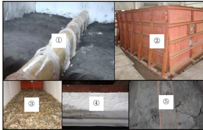
①—隧道衬砌结构; ②—模型箱体; ③—底部碎石; ④—聚氯苯烯泡沫吸能边界; ⑤—断层破碎带
