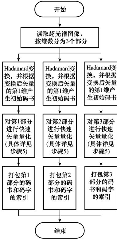
图 1 本文算法流程图
