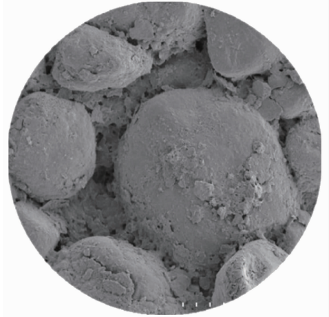
图 7 天然状态的砂岩结构( \times 200SE ) Fig. 7 Natural sandstone structures( \times 200SE )
