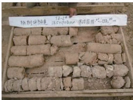
图 6 胡麻岭钻孔砂岩岩心
