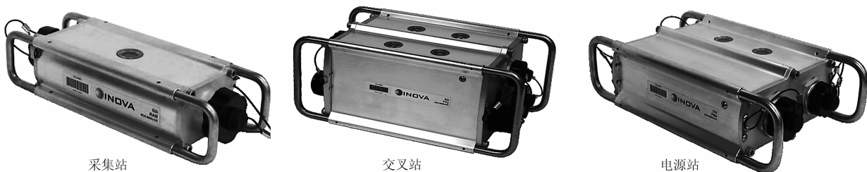
图4 G3i 系统地面电子设备
