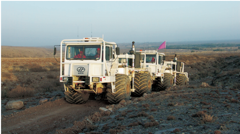
图 5 KZ-28LF 低频可控震源在库车博兹山前带作业
