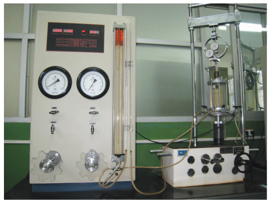
图 2 Tsz30-2.0 型应变控制式三轴仪
