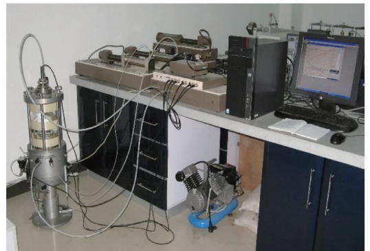
图 1 GDS 三轴剪切试验系统
