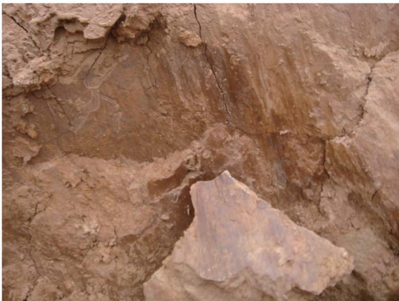
图5 夏藏滩滑坡 I 期滑坡滑面
