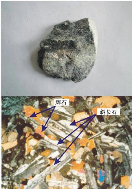
图6 未蚀变辉绿岩块体形态及物质组分(正交偏光, ×20)
