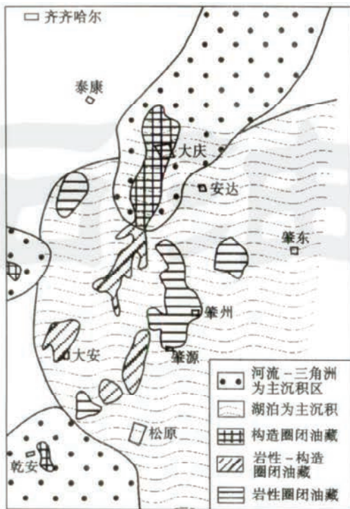
图6 松辽深水拗陷湖盆沉积格架及已发现油气藏类型 ①
