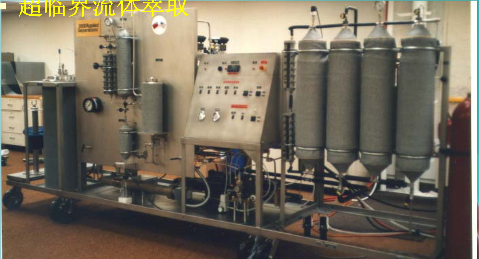
大型超临界流体萃取装置
